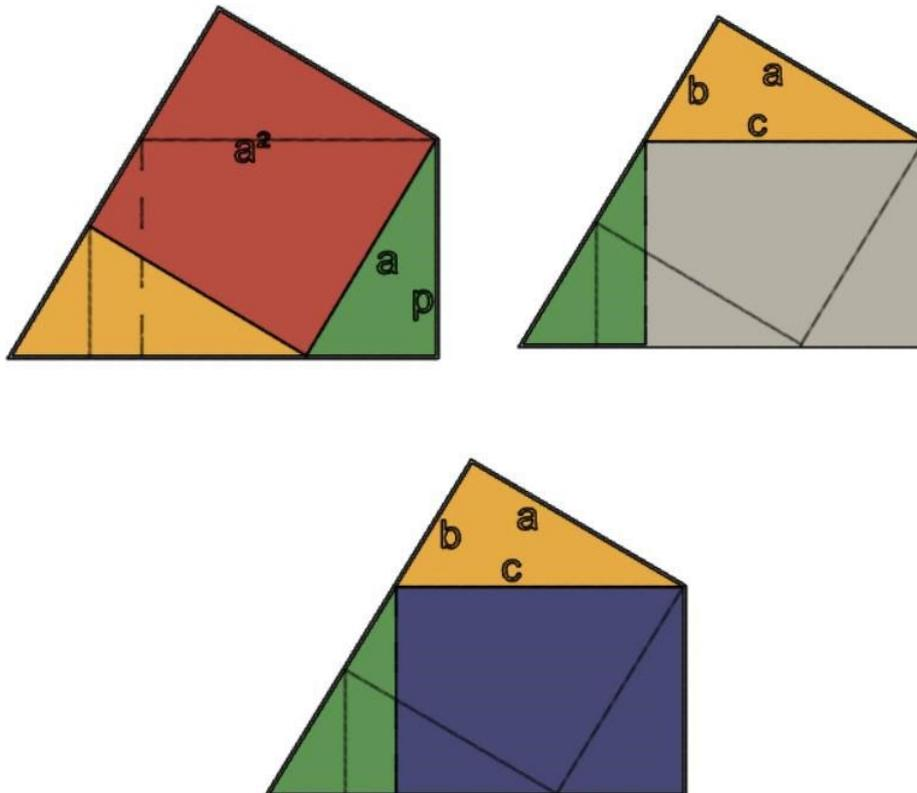
Abbildung 10: Die drei Teile befinden sich in der Basisform (links),  $a^2$  wird weggenommen und die restlichen Teile werden verschoben (rechts), die Form wird mit dem Rechteck  $p \cdot c$  ergänzt (unten)
